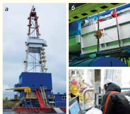
Рис. 2. Автоматизированный дефектоскоп ИНТРОС-АВТО на буровой установке (а); магнитная головка на канате у барабана лебёдки (б); блок управления и индикации в кабине буровищика (в)
